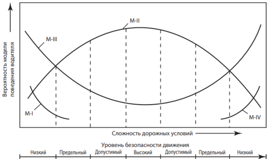
Рисунок 3.2 – Вероятность изменения модели поведения водителя и уровень БДД с учётом дорожных условий, [142]
