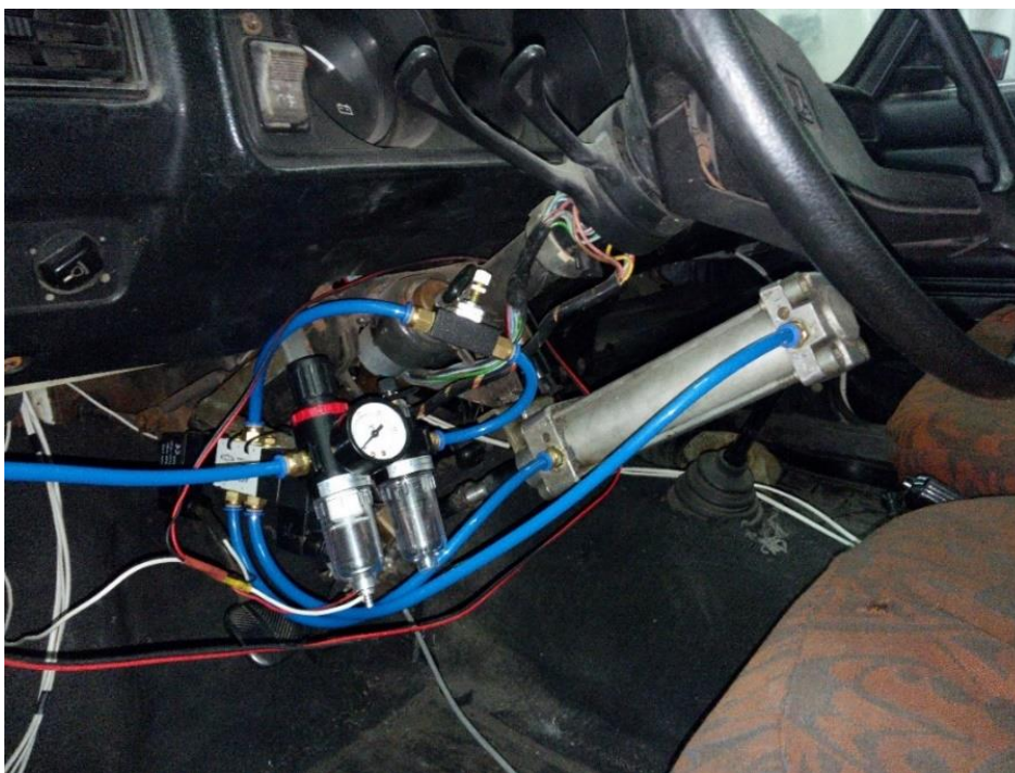
Рисунок 4.3 – Устройство для нажатия на педаль тормоза
