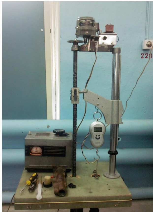
Рисунок 4.2 – Экспериментальная установка для определения триботехнических характеристик резинотехнических элементов
